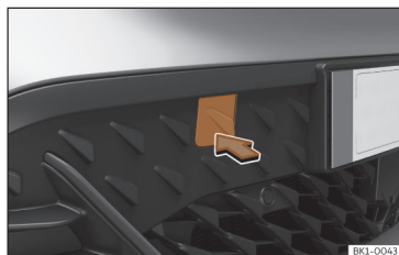
Afb. 177 Aan de rechterzijde van de voorbumper: de afdekking verwijderen.
