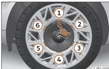
Afb. 192 Wiel verwisselen: de centrale wioldop verwijderen.
