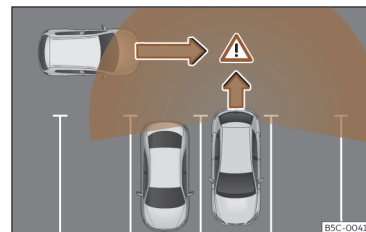
Afb. 147 Schematische voorstelling van de uitparkeerhulp: bewaakt gebied rond de wagen die een parkeerplaats verlaat
