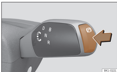
Afb. 133 In de schakelknop: toets van de elektronische parkeerrem.
