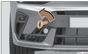
Afb. 224 Voorbumper rechts: ingeschroefd sleepoog.
