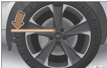
Afb. 254 Wiel verwisselen: wielbouten losdraaien.
