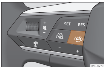
Afb. 130 Linkerzijde van het multifunctiestuurwiel: toets voor de bestuurdershulpsystemen (naargelang het model).
