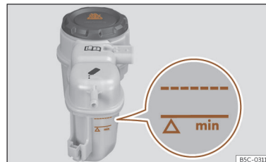
Afb. 236 In de voorruimte: koelvloeistofexpansiereservoir.
