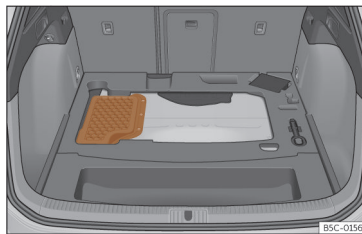
Afb. 244 Hybride wagens (PHEV): locatie van de accu in de bagageruimte
