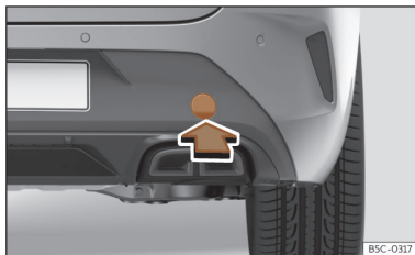
Afb. 225 Leon Sportstourer. Aan de rechterzijde van de achterbumper: de afdekking verwijderen.
