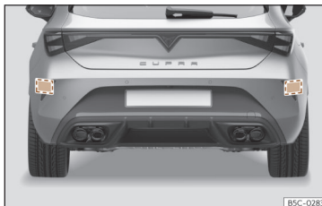
Afb. 134 Achteraanzicht van de wagen: zones van de radarsensoren.
