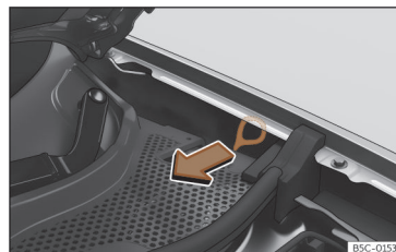
Afb. 65 Tussen het spatscherm links en het scharnier van de motorkap: Hendel voor handmatige noodontgrendeling van de laadsteker.
