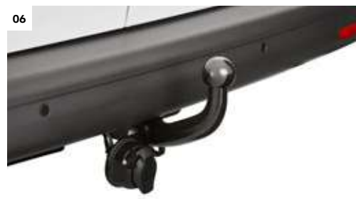
06 Trekhaak, vast, tot 2,5 ton trekvermogen. 3), 7) Gekoppeld aan de aanhangerstabilisatiefunctie 4) van het elektronische stabilisatieprogramma. | BW | DC | KO |
