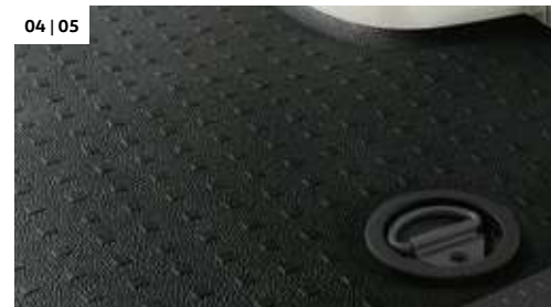
03 Betonplex vloerplaat 9 of 12 mm. 1), 7) Beschermt de bodem en biedt tevens de ideale basis voor het achteraf inbouwen van verschillende soorten kastsystemen. Bestaat uit 9 of 12 mm dik fins berkentriplex afgewerkt met een harde anti slip toplaag met cirkelmotief. Voorzien van verzonken sjoorrog kommen. | BW |
